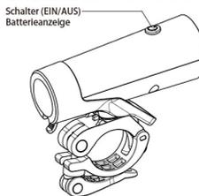
1. Installieren Sie die Halterung am Lenker richtig, so dass der Scheinwerfer sich beim normalen Gebrauch nicht verstellen kann. Verwenden / entfernen Sie beim Bedarf die zur Verfügung gestellte Gummipolster.
