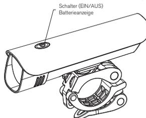
1. Installieren Sie die Halterung am Lenker richtig, so dass der Scheinwerfer sich beim normalen Gebrauch nicht verstellen kann.Verwenden / entfernen Sie beim Bedarf die zur Verfügung gestellte Gummipolster.
